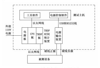
图 5 TRDP设备启动时间测试系统连接
