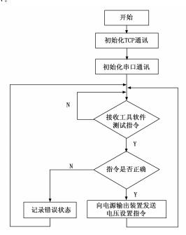
图 2 电源输出控制流程
