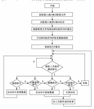
图 3 MVB、TRDP时间统计装置控制流程
