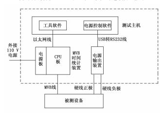
图 4 MVB设备启动时间测试系统连接
