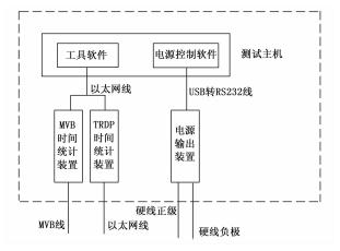
图 1 轨道交通车载设备启动时间测试系统
