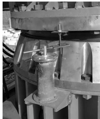
图 7 球铰角度监控编码器
