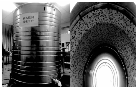
图 14 模拟输水隧洞的水塔场景
