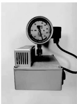
图 2 SF 6 密度继电器在线校验装置
