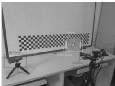
图 8 三相机组对内参的标定
