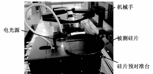
图 7 硅片预对准台 CCD 测量系统
