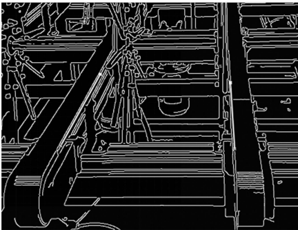
图 12 检测出的传送带边缘
