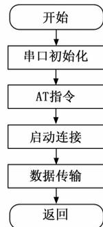
图 11 WiFi 通信软件设计流程图
