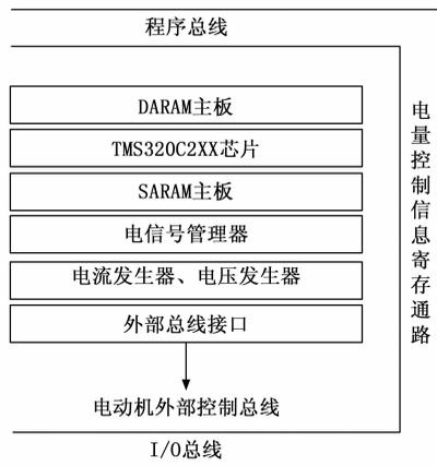
图 4 DSP 控制板的功能框图
