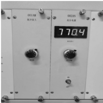
图 9 程控高压电源模块和程控脉冲放大模块
