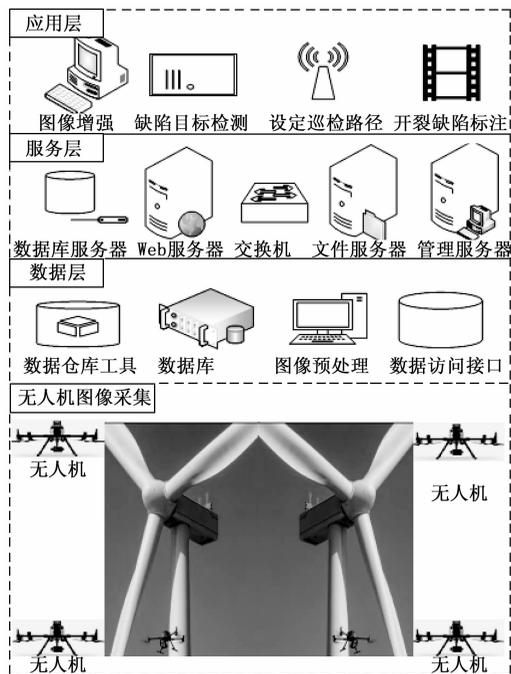
图 1 风电机组叶片缺陷检测系统结构
