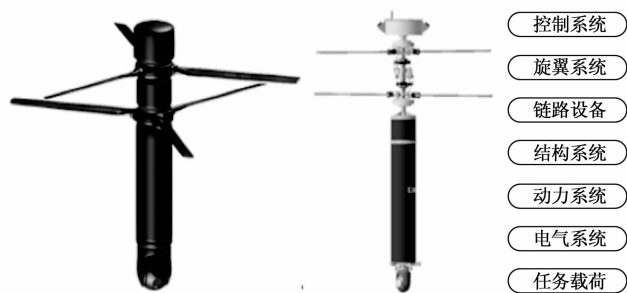
图 4 共轴双旋翼无人机组成
