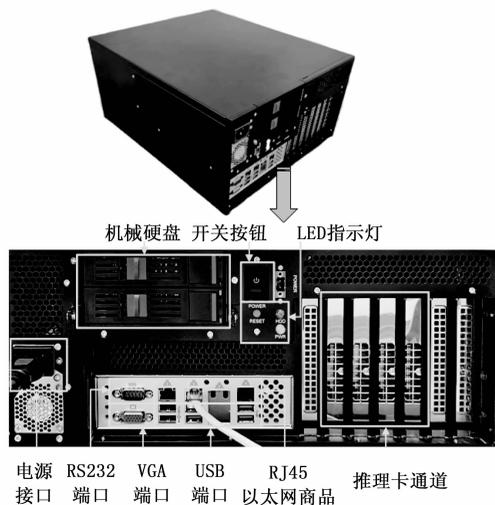
图 2 设备硬件结构及接口示意图
