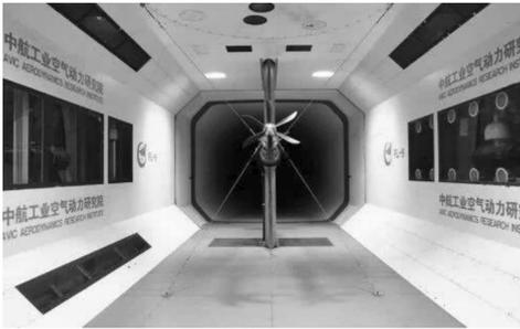
图 7 风洞螺旋桨滑流单桨试验图
