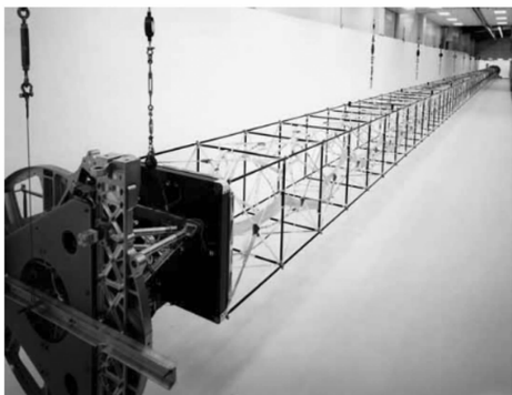
图 1 美国“奋进号”航天飞机 SRTM 系统上的 60 m 长大型空间桁架结构
