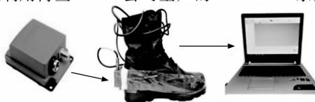
图 2 惯性行人导航系统实物模型
