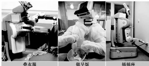
图 2 PR2 机器人完成各项任务
