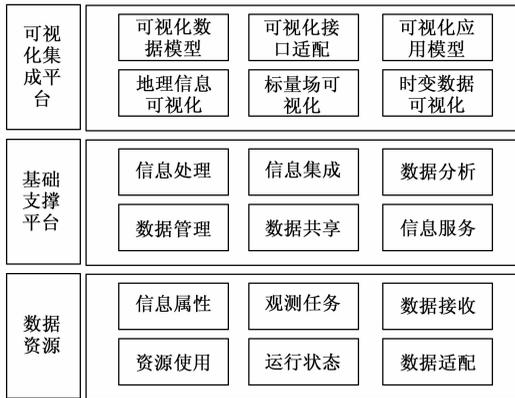
图 1 高分对地观测系统整体结构
