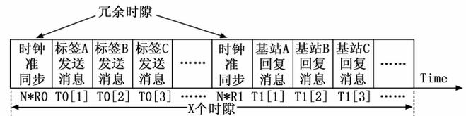
图 6 时隙分配示意图
