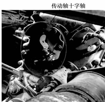
图 9 变速箱至分动箱传动轴损坏
