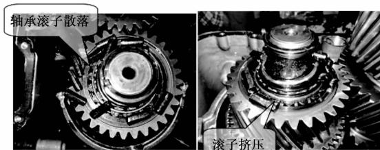
图 3 变速箱主轴前轴承损坏情况
