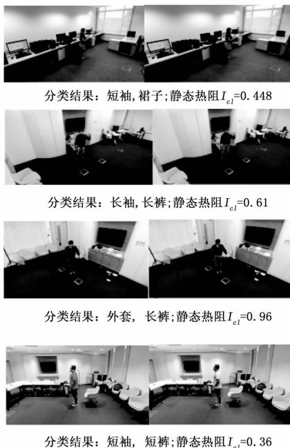
图 8 服装检测和静态热阻预测结果
