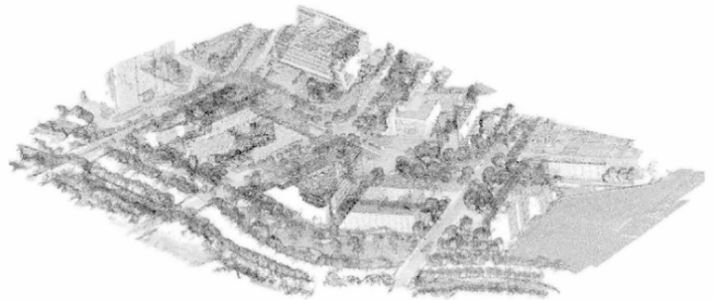
图 5 无人机倾斜摄影生成的点云
