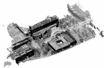
图 9 无人机点云建筑立面提取
