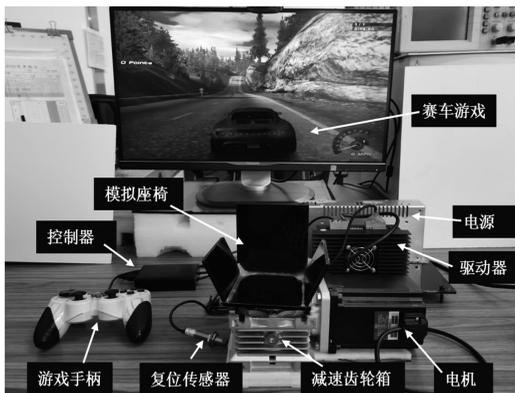
图 7 游戏场景下座椅同步控制实验装置
