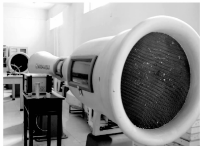
图 5 风洞模拟测控系统现场图
