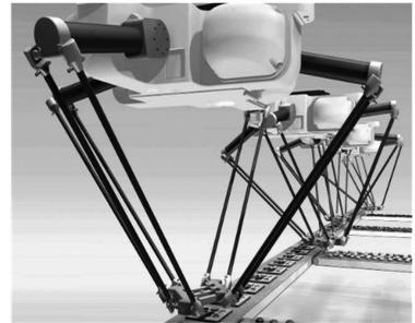
图 3 分拣机器人示意图
