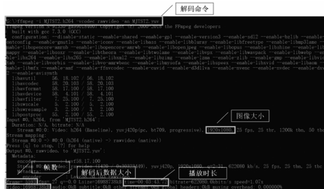
图 14 FFmpeg 解码 H. 264 码流文件
