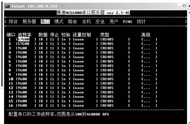
图 4 串口服务器串口配置图
