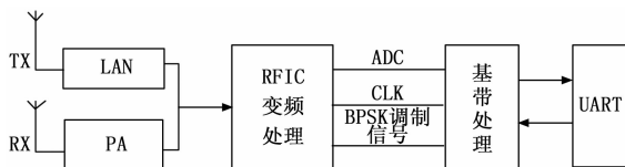
图 6 北斗模块 RDSS 原理框图
