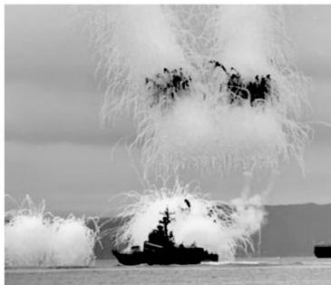
图 3 舰船发射箔条弹
