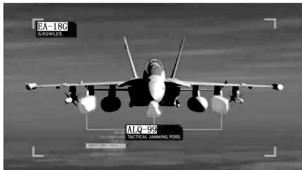
图 2 AN/ALQ-99 大功率压制干扰系统
