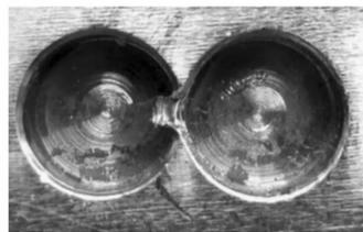
图 8 双孔微剪切试验现象
