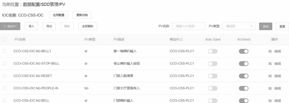
图 5 门禁控制 PLC 变量
