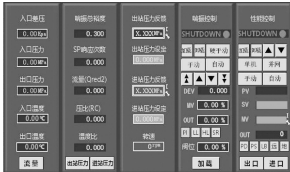
图 3 压缩机负荷分配控制面板
