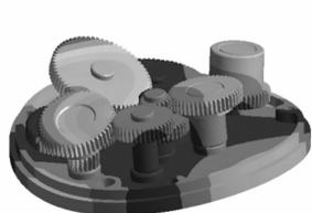
图 13 第五阶模态 6 120 Hz
