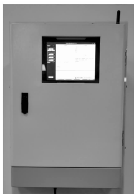
图 4 水体有机物在线荧光监测仪照片
