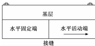
图 5 水平位移引起基层开裂示意图
