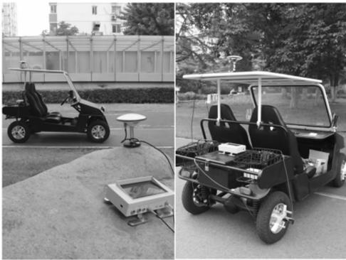
图3 成套测量装置及试验车辆
