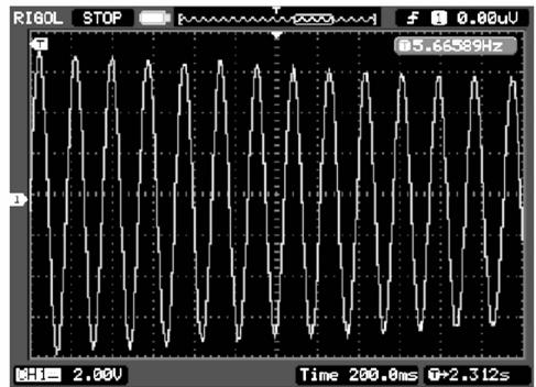
图 7 机械臂的自由振动曲线
