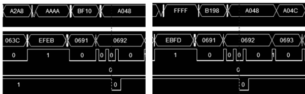
图 4 错误装载 (地址 02000691, 错误数据 BF10 和 B198, 正确数据应为 BF98)
