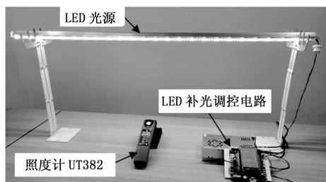
图 7 补光调控电路的实验测试图
