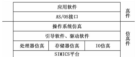
图 3 EEC 软硬件仿真架构
