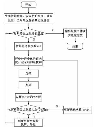
图 1 改进 SAPGA 算法流程图
