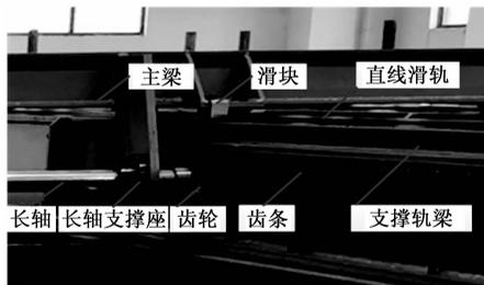
图 6 平移机构结构
