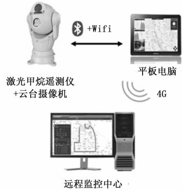
图 2 车载激光甲烷遥测系统组成图
