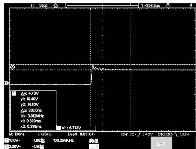
图 8 充电电流波形
