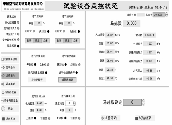
图 10 进气系统操作界面
