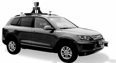
图 1 基于野马 E70 电动汽车改造的智能车驾驶平台
