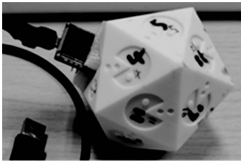
图 2 IMU 阵列校正装置
