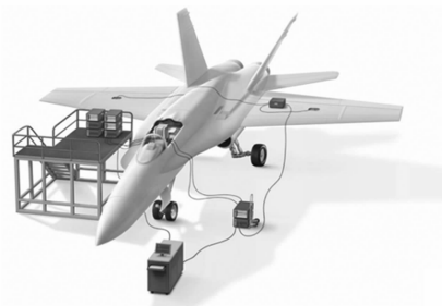
图 3 航空整机电缆检测系统机上布局连接示意图
