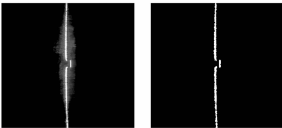
(a) 通过滤光片的焊缝图像 (b) Steger 图法得到的焊缝图像
