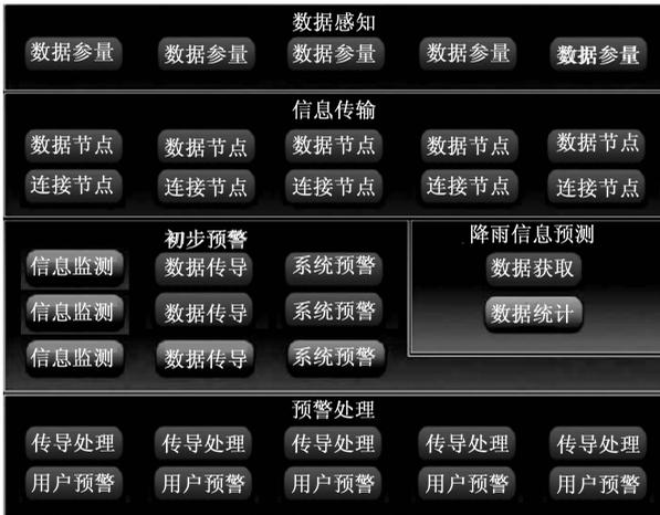
图 3 监测预警系统组成结构
